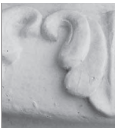
Рис. 1. Качество поверхности фибробетонов Fig. 1. Surface quality of fiber-reinforced concrete
