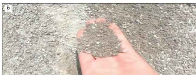
Рис. 1. Отходы местных производств: а – 5–20 мм, мелкофракционный; б – 0–5 мм, отсев дробления
