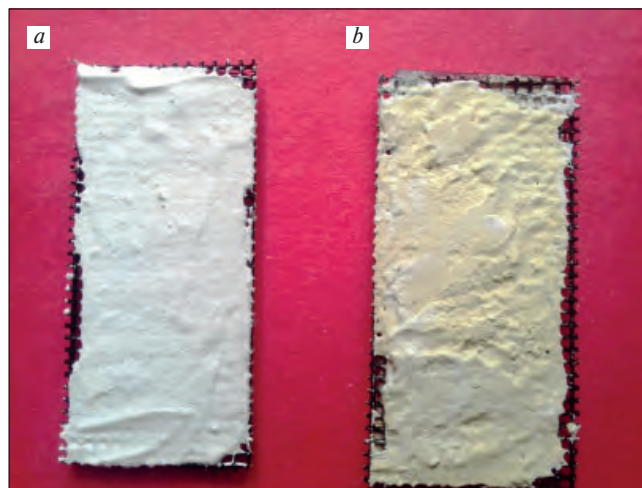
Рис. 2. Шпатлевка Vetonit LR+: а – шпатлевка без добавки; б – с \text{TiO}_2 -содержащим компонентом
