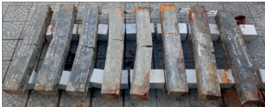
Рис. 6. Результаты испытаний на растяжение при изгибе бетонных образцов-балок, стальные арматурные стержни в которых были подвергнуты коррозии под действием постоянного электрического тока Fig. 6. Results of tensile tests in bending of concrete specimens-beams, steel reinforcing bars in which were subjected to corrosion under the action of direct electric current
