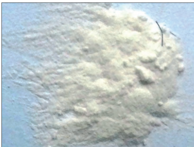
Рис. 1. Образец материала, полученного нанесением диоксида титана на каолинит
