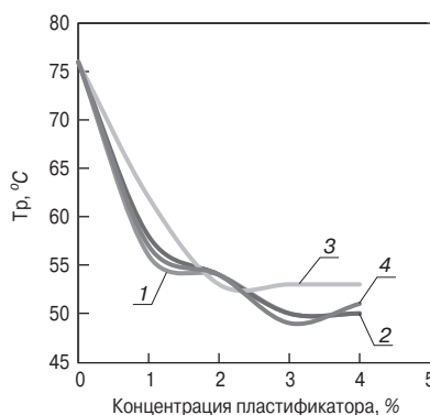
Рис. 3. Зависимость температуры размягчения вяжущего от концентрации дисперсии: 1 – Tr-°C(И-20А) после девулканизации; 2 – Tr-°C(И-20А+ОУНТ) после девулканизации; 3 – Tr-°C(И-20А) до девулканизации; 4 – Tr-°C(И-20А+ОУНТ) до девулканизации
