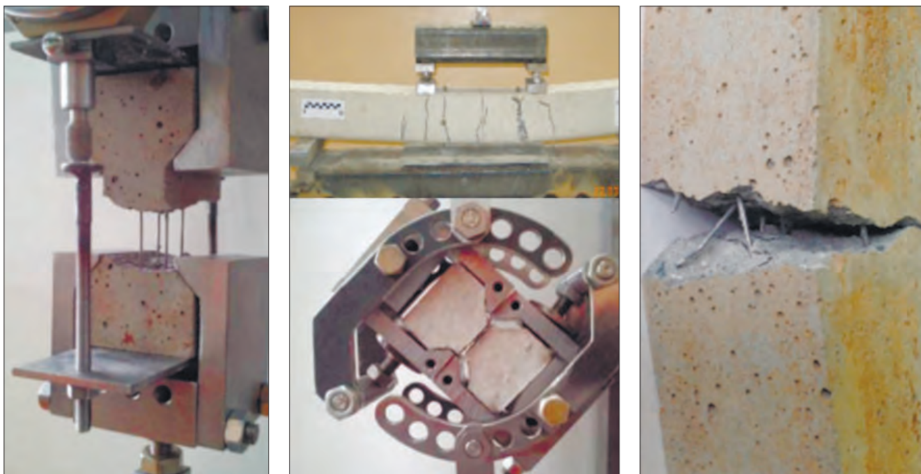
Рис. 4. Определение физико-механических свойств СФШБ Fig. 4. Determination of the physical and mechanical properties of SFSC
