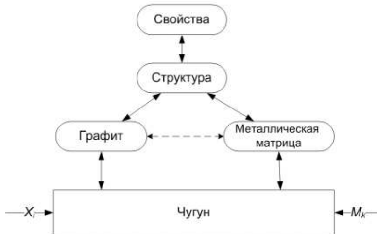
Рис. 1. Модель обеспечения рациональной структуры в графитизированных чугунах
