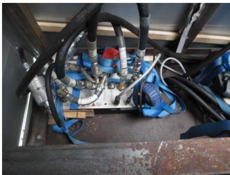
Рис. 7. Установка расходомера DFL3x в кузове автомобиля
