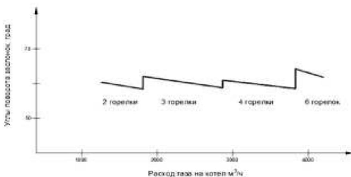
Рис. 3. Характер регулирования расхода газа на котёл изменением количества работающих горелок и углов поворота заслонок
