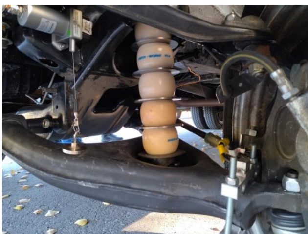
Рис. 10. Внешний вид подвески автомобиля с эластомерным пакетом и установленными датчиками
