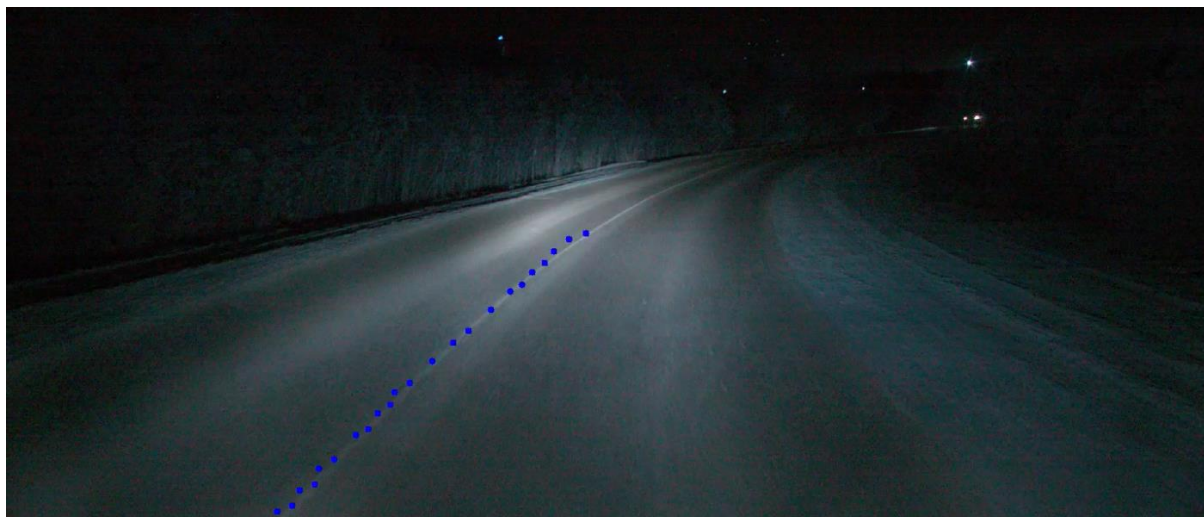
Рис. 5. Испытания в темное время суток при сухой погоде с частично стертой дорожной разметкой. Синими точками обозначена распознанная дорожная разметка
