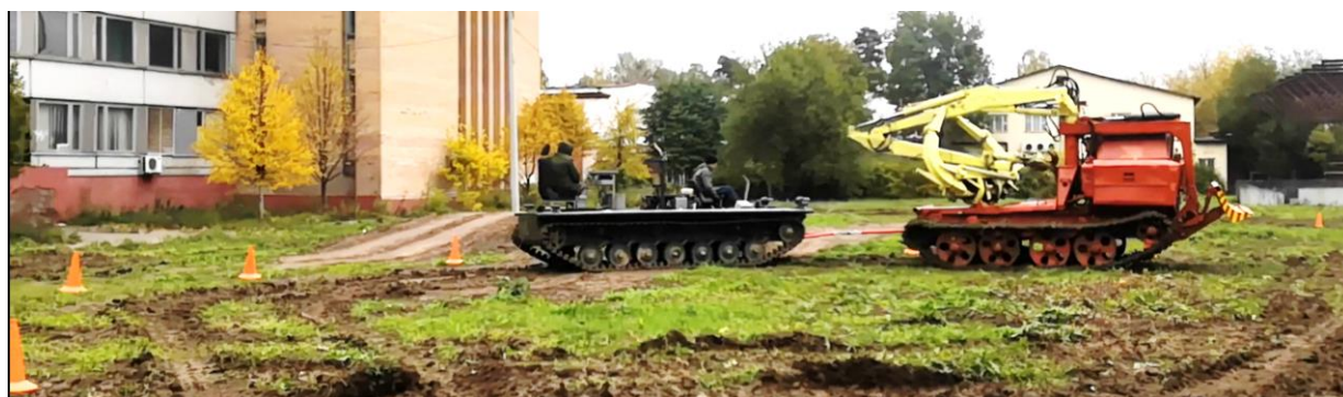
Рис. 13. Гусеничный поезд в процессе выполнения маневра «змейка»
