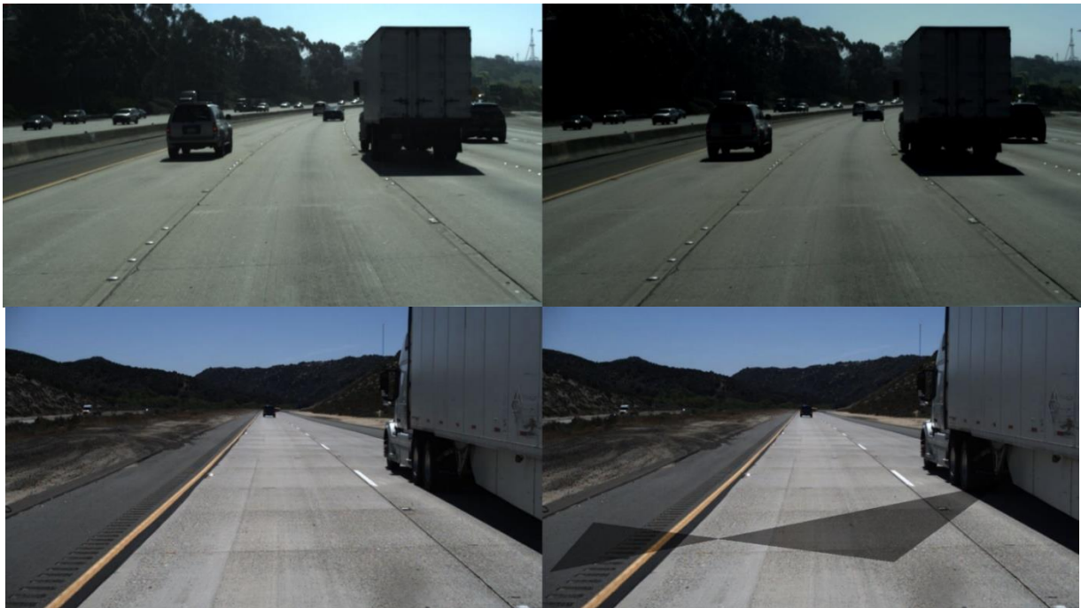
Рис. 1. Аугментация данных для обучения нейронной сети путем добавления на видеокادر специальных эффектов, имитирующих различные дорожные условия
